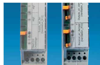
DESIGO I/O modulok kézi vezérléssel és felirattal
